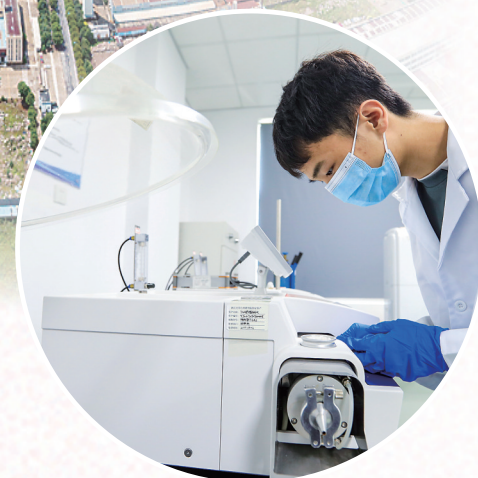
技术人员在做TG热失重分析实验。
