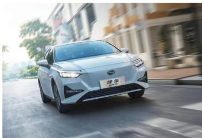
绎乐EA6电驱系统采用集成化设计，搭载永磁同步驱动电机，最大功率135kW，最大扭矩300Nm，匹配高能量密度的三元锂离子电池，NEDC综合工况续航里程达510km，0-50km/h加速仅3.5S。
