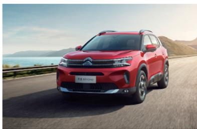
天逸 BEYOND 的长宽高分别为 4510mm × 1860mm × 1705mm,轴距为 2730mm。车身高度将直接影响车辆通过性和乘坐时的头部空间,轴距将直接影响乘坐时的纵向空间。
