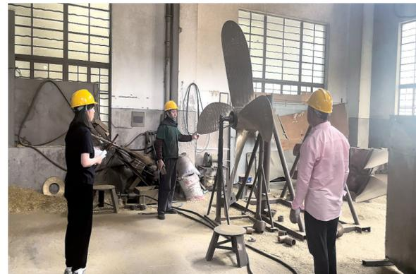
验船师朱海琪(左一)在永固螺旋桨厂对产品进行静平衡检测。
