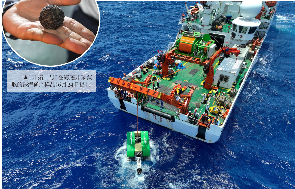
上海交通大学自主研制的深海重载作业采矿车工程样机“开拓二号”海试现场(无人机照片,6月22日摄)。
